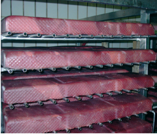
Abb. 3: Nach ein- bis zweiwöchiger Fermentation in der verschlossenen Form erfolgt die Weiterbehandlung (Reifung, Räucherung) der ausgeformten Schinken.
